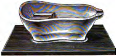
Porzellanwanne für Quecksilber zum Auffangen von Gasen.
